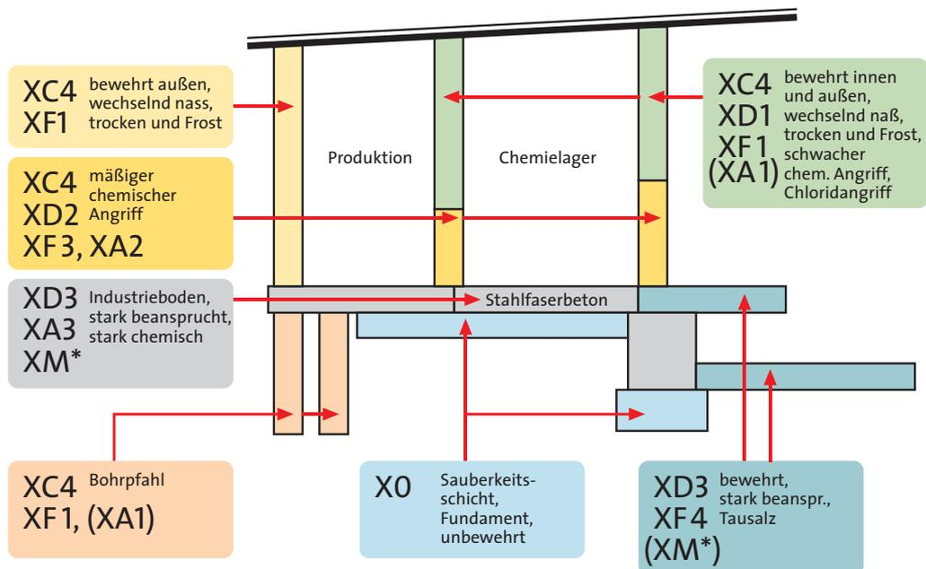
XM\* Verschleißbeanspruchung abhängig von der späteren Nutzung (XA1) wenn erforderlich, muss Betonkorrosion durch chemischen Angriff berücksichtigt werden
