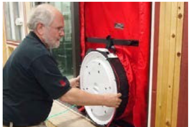
. blower door test (Luftleckage)
