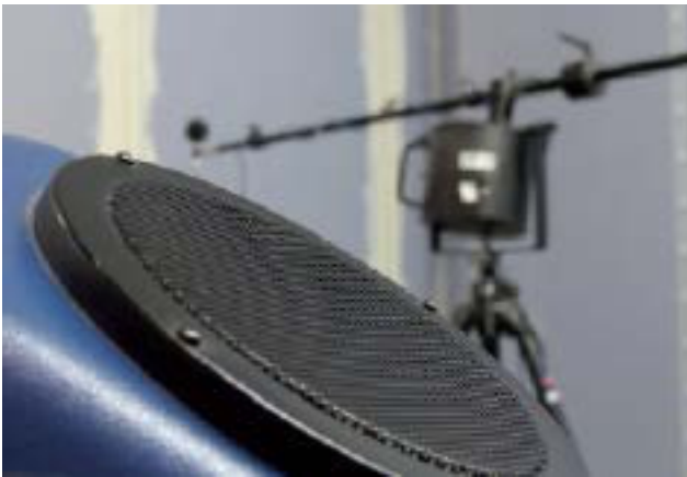
Bild. Akustische Prüfung der Wände – Luftschall Bild
