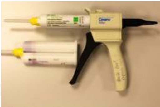
Abb. 8 - Replika Methode - zwei Kartuschen mit dünnfließendem Silikon
