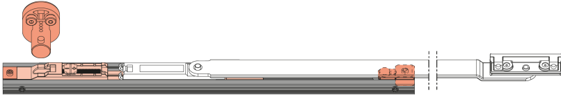
Abb.36: Einstellung Öffnungsbegrenzer abschließbar Fig.36: Positions opening limiter lockable
